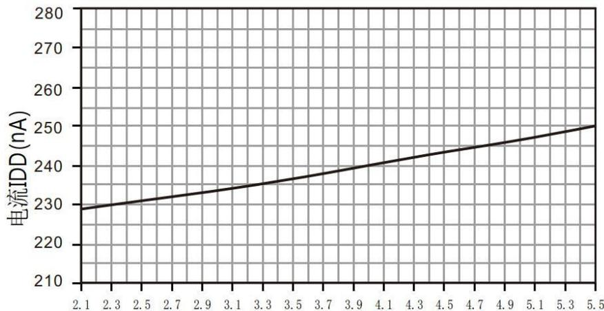
图6. 在温度为25°C时，典型的供电电流与供电电压的关系曲线（休眠模式）。
