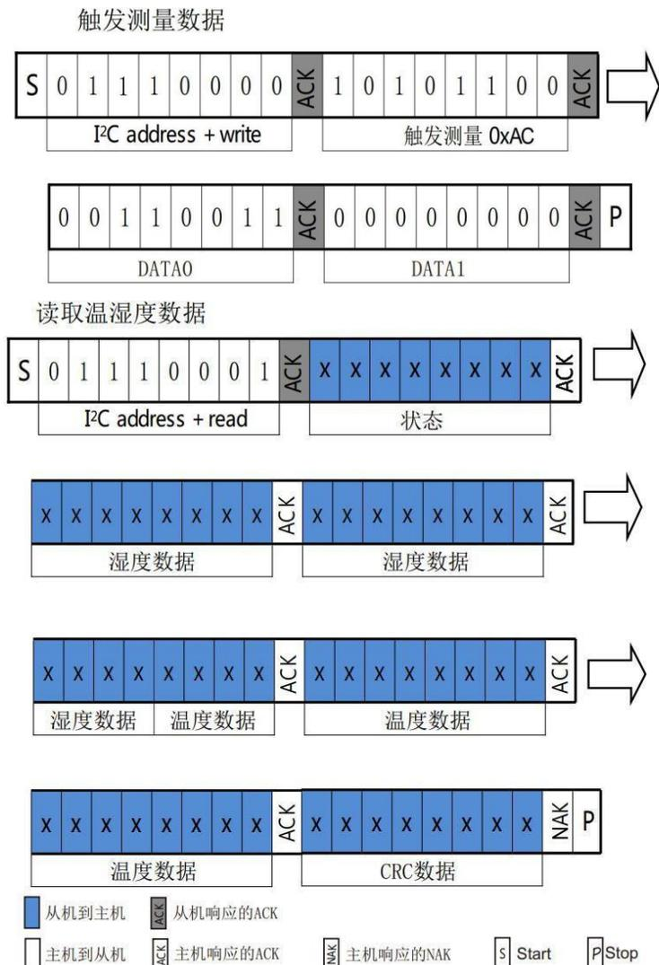
注：传感器在采集时需要时间，主机发出测量指令（0xAC）后，延时80毫秒以上再读取转换后的数据并判断返回的状态位是否正常。若状态比特位[Bit7]为0代表数据可正常读取，为1时传感器为忙态，主机需要等待数据
